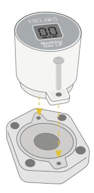
Una vez instalado la pantalla del medidor de gas Cuby Helios debe marcar el porcentaje de gas que tiene el tanque. Es normal ver un error de ± 1.5% pero no debería ser más
