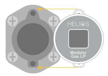
4 Utilizar los 2 tornillos incluidos para atornillar el nuevo medidor de gas al tanque. Asegurar que quede bien atornillado pero tener cuidado de no apretar de mas para evitar barrer la rosca.
