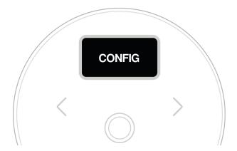
Si no dice "CONFIG" entonces hay que retirar el panel de cristal con ayuda del accesorio de desmonte y dejar presionado el botón que dice "CONFIG" por 5 segundos hasta que la pantalla diga "CONFIG".
